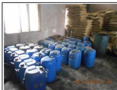
Niezgodność: Brak wydzielonej przestrzeni do składowania chemikaliów
